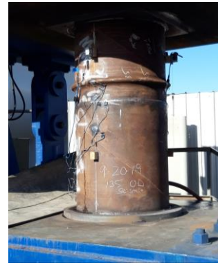
τελικό στάδιο παραμόρφωσης, το κύμα έχει «διπλώσει»
