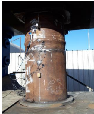
πρώτο στάδιο παραμόρφωσης, δημιουργία αρχικού κύματος λυγισμού
